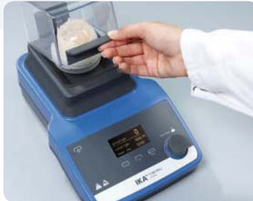
Bước 5 | Lấy buồng nghiền ra khỏi máy nghiền
